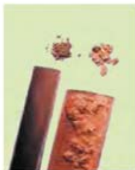
Продукты коррозии Ржавчина ( Fe_2O_3 ) и магнетит ( Fe_3O_4 )
