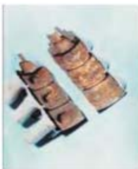
Загрязнённый нагревательный элемент (в разрезе)
